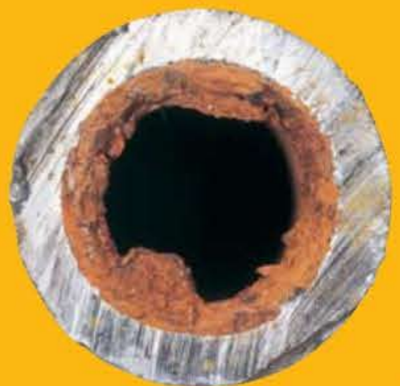
鉄サビや汚れが付着した 水道管の断面写真
